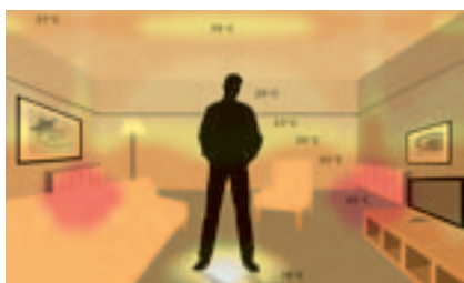
Vyzařování tepla z konvenčních topných systémů s radiátory. Velké teplotní rozdíly v místnosti (18-65 °C).
